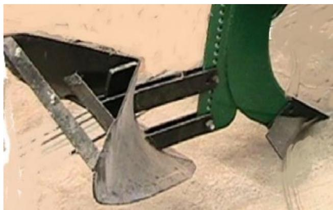
Figura 2.3. Escarificador con saetas de 400 mm y surcador para la labor de profundización y surque (Fuente: Betancourt et al., 2023)
