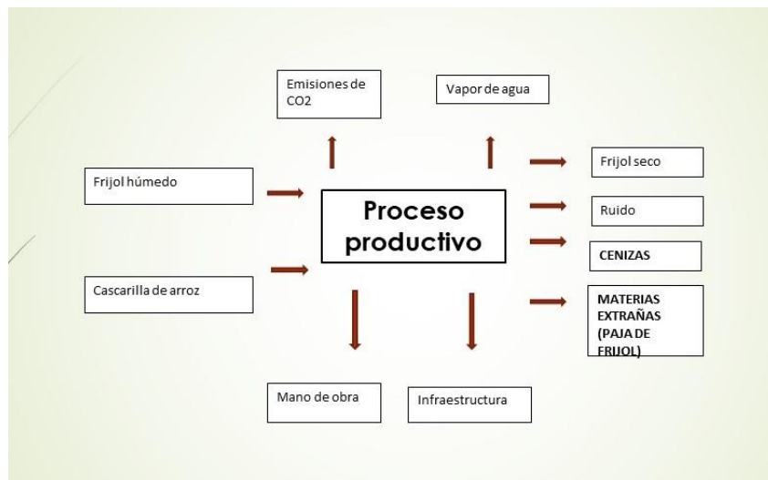
Figura 3.2 Balance Masa y energía Planta de Secado y beneficio de granos “Eduardo Lamas Díaz”
