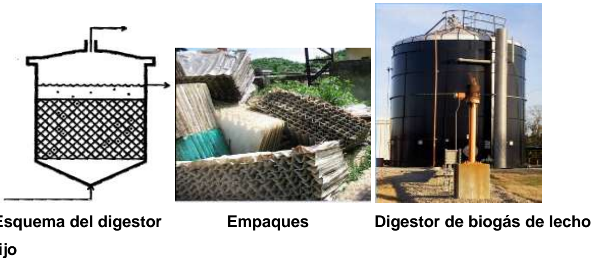
Figura 2- Planta de biogás de lecho fijo
