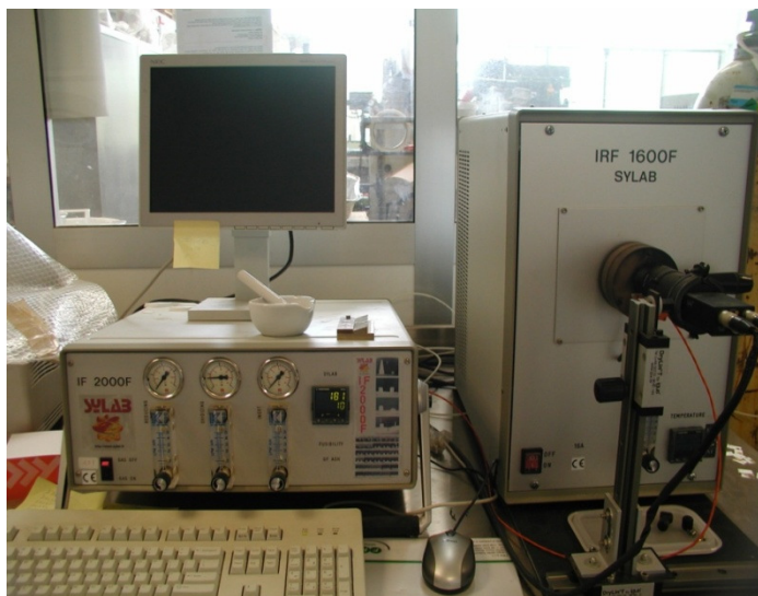
Syba IF 2000F instrumento utilizado para determinar la fusividad de las cenizas (CEN/TS 15404-1).
