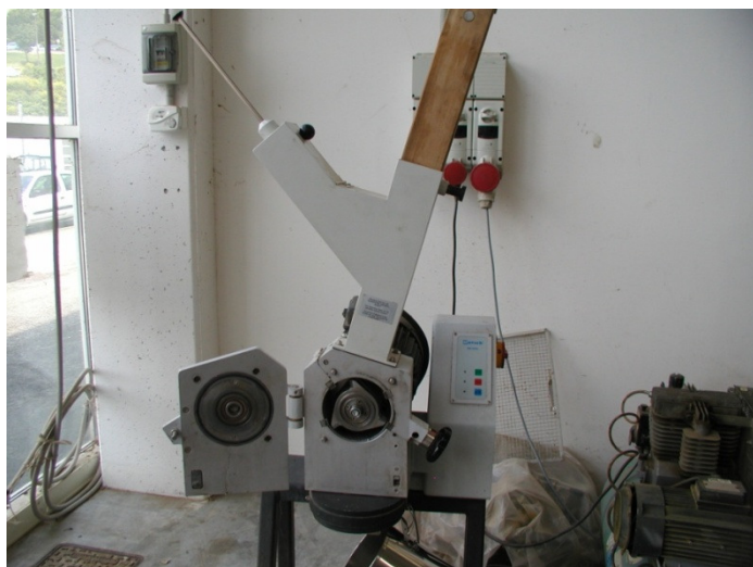
Molino Retsch SM2000 utilizado para la trituración del material a 1mm tamaño de partícula (CEN/TS 14780).
