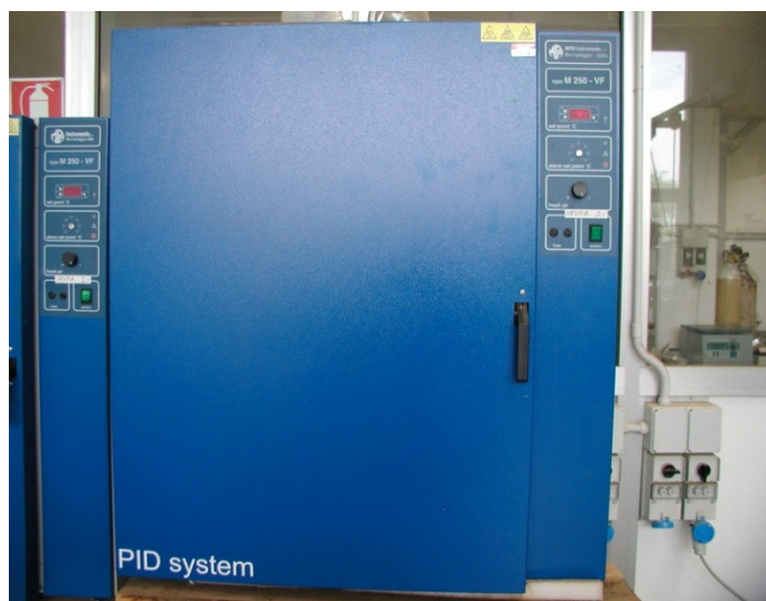
Estufa utilizada para determinar la humedad del material a 105°C por 24 horas (CEN/TS 14774).
