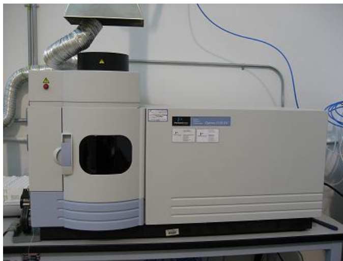
PerkinElmer Optima 2100 DV para determinar otros elemento químicos por espectrometría de emisión óptica (CEN/TS 15297).
