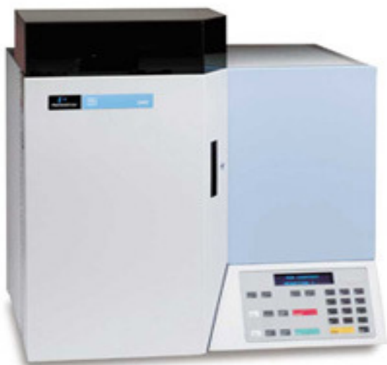
PerkinElmer 2400 CHNO/S para determinar análisis elemental (C, H, N) (CEN/TS 15104).
