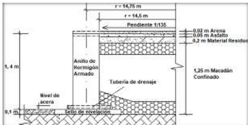
Figura 3. Detalle de la cimentación (Acosta, 2009).
