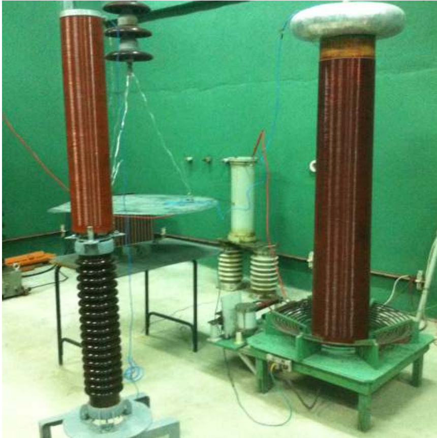
Figura 2. Vista del simulador de descargas de rayo.
