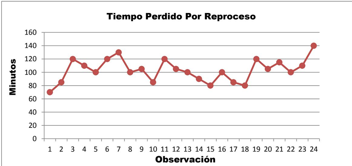
Figura 3.6. Gráfico que representa el comportamiento del tiempo perdido por reproceso debido a los defectos ocurrido por equipos durante el proceso de reparación de chapistería del refrigerador.
