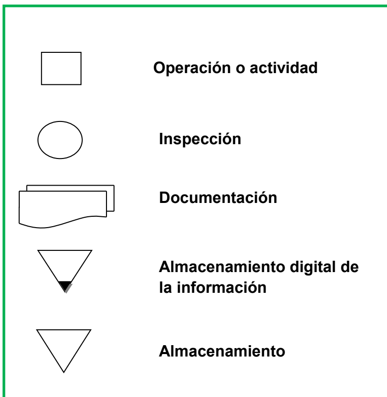
Figura 2.2: Símbolos utilizados para la representación gráfica en el mapa de proceso y el diagrama de flujo de proceso. Fuente: Gutiérrez García, 2014
