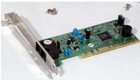
**Figura 14:** Modem Interno de PC.
