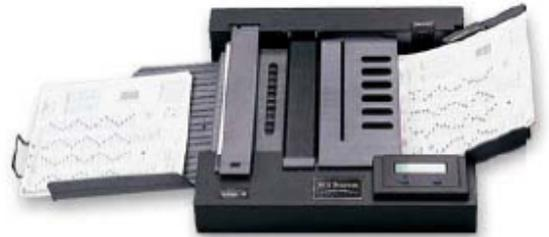
**Figura 21:** Lector óptico de marcas.
