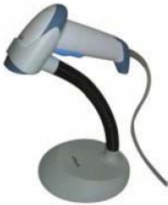
**Figura 20:** Detector óptico de barras impresas.
