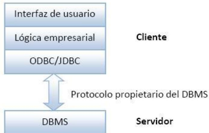
**Figura 2: Conexión con un DBMS en la arquitectura cliente-servidor con dos capas.**
