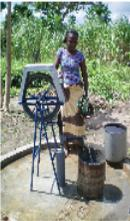
La bomba de sogá es un tipo de bomba de fácil construcción y bajo costo que puede ser operada manualmente con poco esfuerzo. Generalmente se utiliza para extraer agua de pozos subterráneos para uso doméstico, para riego de huertas y pequeños cultivos o para abastecer de agua al ganado.
