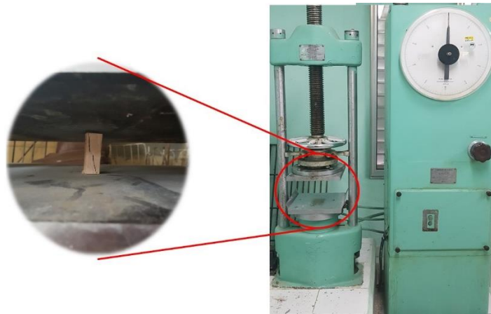
Figura 13: Prensa rusa marca 3NM utilizada en los ensayos de compresión.
