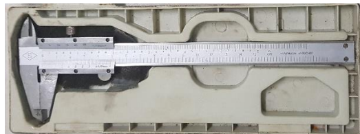
Figura 12: Pie de rey marca Stainless Hardened de 0.01 mm de precisión.
