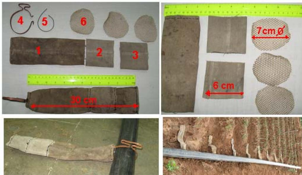
Figura 3.1 Representación esquemática del calcetines antiersivo. *Partes del calcetín: 1,2, 3 fracciones de lona. 4 el accesorio de alambre que ajusta el calcetín a la tubería; 5 accesorio de alambre del cual se acopla el accesorio 4 y 6 fracciones de malla. Fuente: Elaboración propia*
