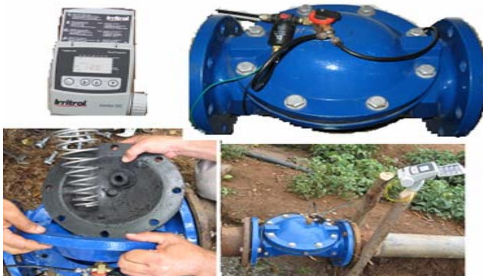
Figura 3.3: Válvula Automática Hidráulica de Control Cerrada **FLUCON DN150** y el programador modelo **IRRITROL** (JRDC-1-R). Fuente: Elaboración propia
