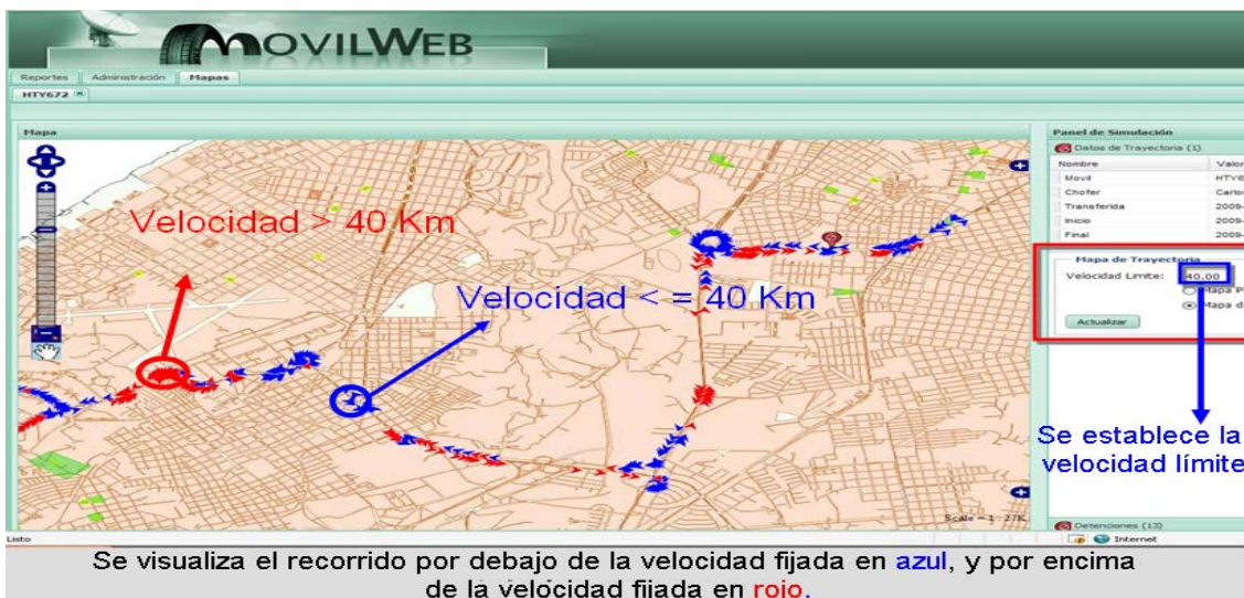
Figura. 3.8 Ejemplo ilustrativo de evaluación de velocidad del vehículo. Programa DIFERIDO.
