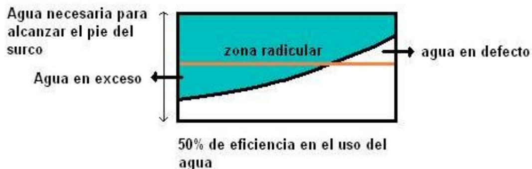
Figura 1: Patrón típico de humedecimiento del riego continuo.
