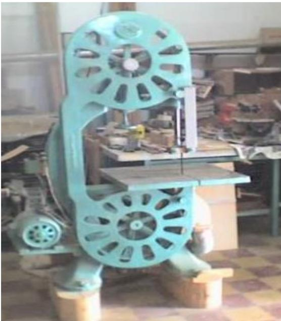
En la imagen se pueden apreciar los dos elementos esenciales: las volantas, que son circulares y la cinta que une las dos volantas.
