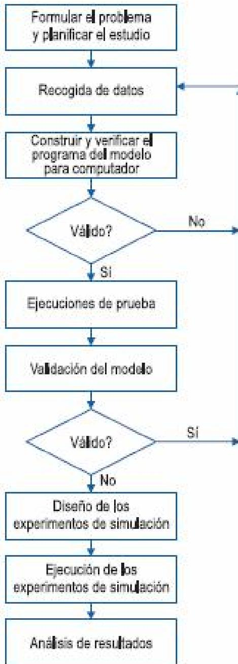
Figura 2.2 Procedimiento para la modelación y simulación de sistemas discretos.
