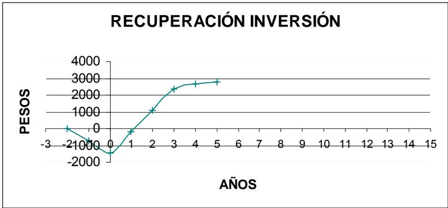
**Figura No.3.- Diagrama resultante cálculo económico del aislante para la cámara de congelación.**
