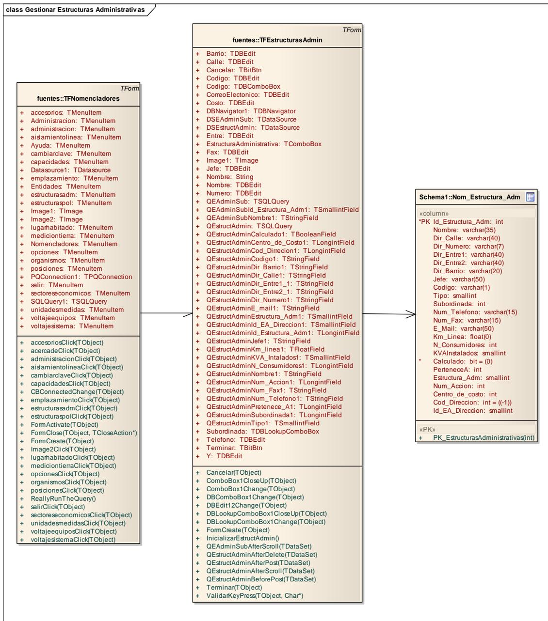
**Figura 9.** Diagrama de clases del diseño para el caso de uso Gestionar Estructuras Administrativas.
