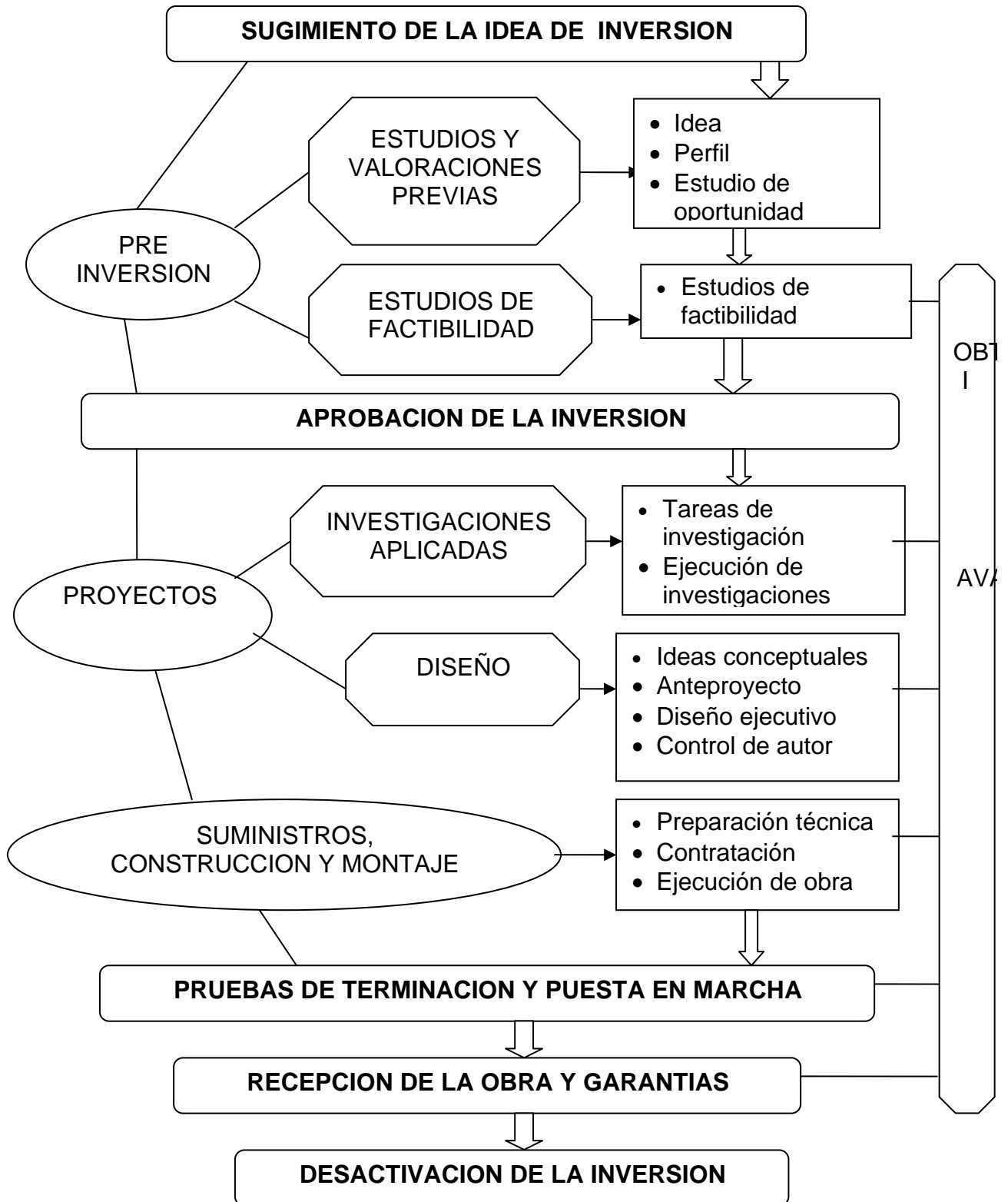
Figura 2.1 Proceso de ejecución de las inversiones
