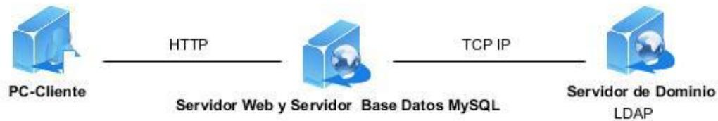
Figura 14: Diagrama de despliegue.
