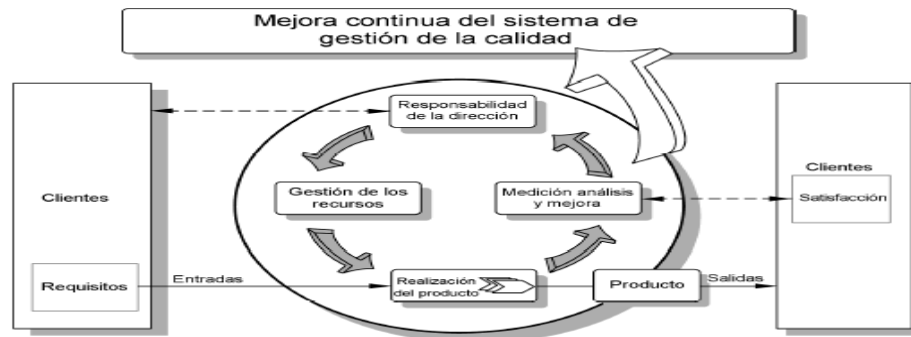
Figura 1. 3 Modelo de un Sistema de Gestión de la Calidad basado en proceso. Fuente: ISO 9001:2008.
