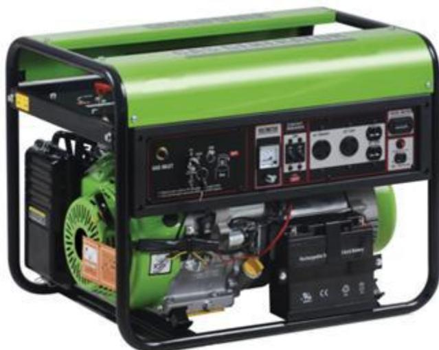
Con una relación de consumo de biogás de 0.55 a 0.65 m<sup>3</sup> / kWh, potencia nominal de 1200 W, potencia máxima de 1300 W, salida DC / AC 12V a 8.3 A, generador monofásico con motor de brocha, tiempo de trabajo continuo no más de 6 horas (Venta caliente 3kw 5kw 10kw).
