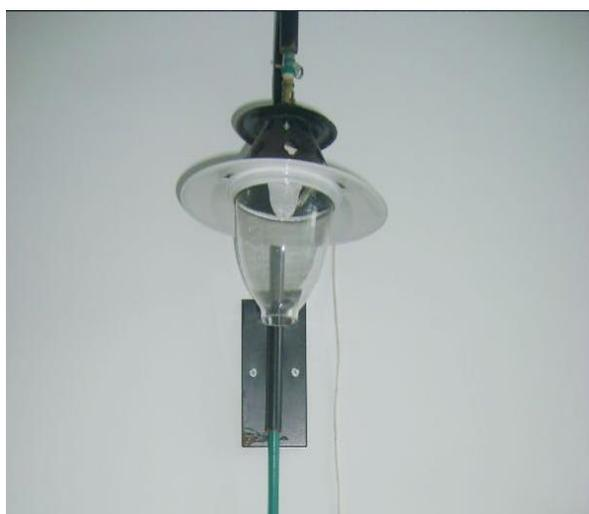
La cual es equivalente a un foco incandescente de 60 a 100W y con un consumo de biogás de 0.07 m<sup>3</sup>/h, (Hannover Biogas lamp).
